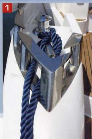
**1** Degno di nota il disegno del passacavo che grazie alle tre posizioni possibili consente alle cime d'ormeggio di lavorare sempre nel modo migliore. Di serie anche il winch di tonneggio e un pratico gavone per le cime su entrambi i lati. **2** In quadrato, interessante la possibilità di ampliare la dinette grazie alle due sedute mobili di cui è dotato il divanetto posto di fronte.
